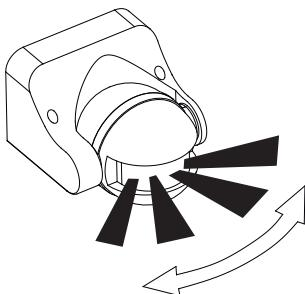
Die sicherste Bewegungserfassung erzielen Sie, wenn der Sensor seitlich zur Gehrichtung montiert wird.
