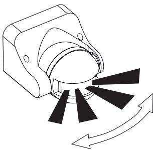
Il rilevamento del movimento più sicuro si ottiene quando il sensore è montato lateralmente al direzione di marcia.
