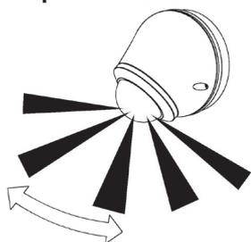
Il rilevamento del movimento più sicuro si ottiene quando il sensore è montato lateralmente al direzione di marcia.
