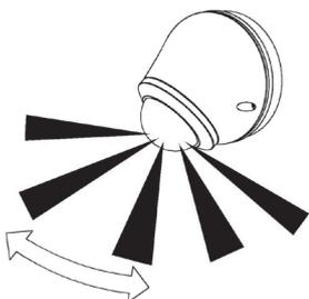
La détection du mouvement plus sûr s'atteindre, quand le détecteur est monté latéralement à la direction de marche.
